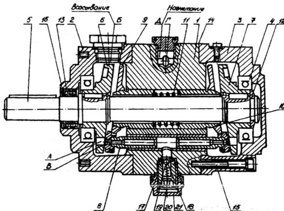
Насос состоит из корпуса 1, крышек 2 и 3, в которых расположены подшипники 4 приводного вала 5. На приводном валу расположены наклонные диски 6 и 7, на которые через гидростатически разгруженные подпятники опираются поршни 8. Поршень с подпятником соединяется посредством сферического шарнира и представляет собой неразъемное соединение. Постоянный контакт подпятников с наклонными дисками достигается с помощью прижимных дисков 9, опирающихся через сферическую опору стакана 10 на пружину 11.
